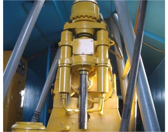
Рисунок 4 – Буровая установка УПБ-5 и буровой станок ЗИФ-1200
